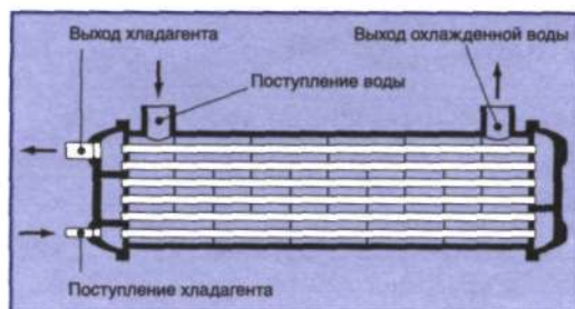
Рис. III.21. Схема кожухотрубного испарителя
