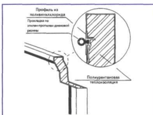
Рис. III.123. Вид панельной обшивки
