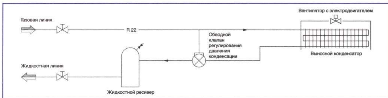
Рис. III.146. Принципиальная схема выносного конденсатора для работы до температуры наружного воздуха минус 35 °С
