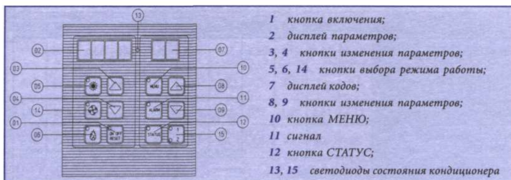
Рис. III.128. Схема контрольного щитка шкафных кондиционеров CA и CAR с двумя холодильными контурами
