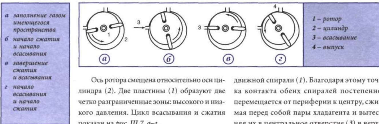
Рис. III.7. Ротационный компрессор с двумя подвижными пластинами
