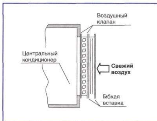
Рис. III.161. Воздушный клапан, установленный на входе в центральный кондиционер (привод не показан)
