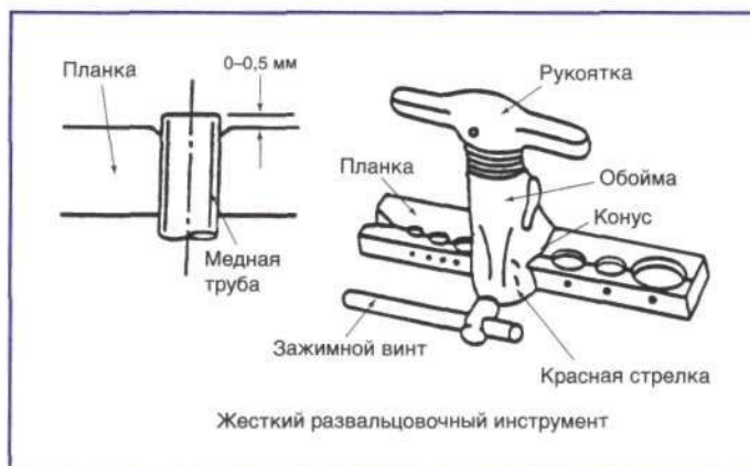
Рис. VIII.21. Развальцовка медного трубопровода
